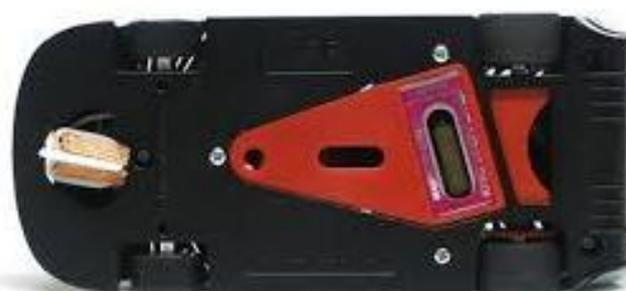
Las especificaciones técnicas del modelo son las siguientes, una longitud de 143,5 mm, una anchura de 64,1 mm y una altura de 29,95 mm. La distancia de la guía al Eje trasero es de 100,80 mm y la distancia entre ejes: 81,90 mm. El peso total del coche 80 grs y el de la carrocería es de 16,5 grs. El motor es un King 21 EVO 3 con 21400 RPM.
