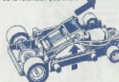
Saque la placa del circuito electrónico como ya se ha dicho. Presione las escobillas del motor, libere el muelle los contactos a la placa del circuito electrónico, coloque de nuevo el muelle en su lugar, para sujetar las escobillas.
