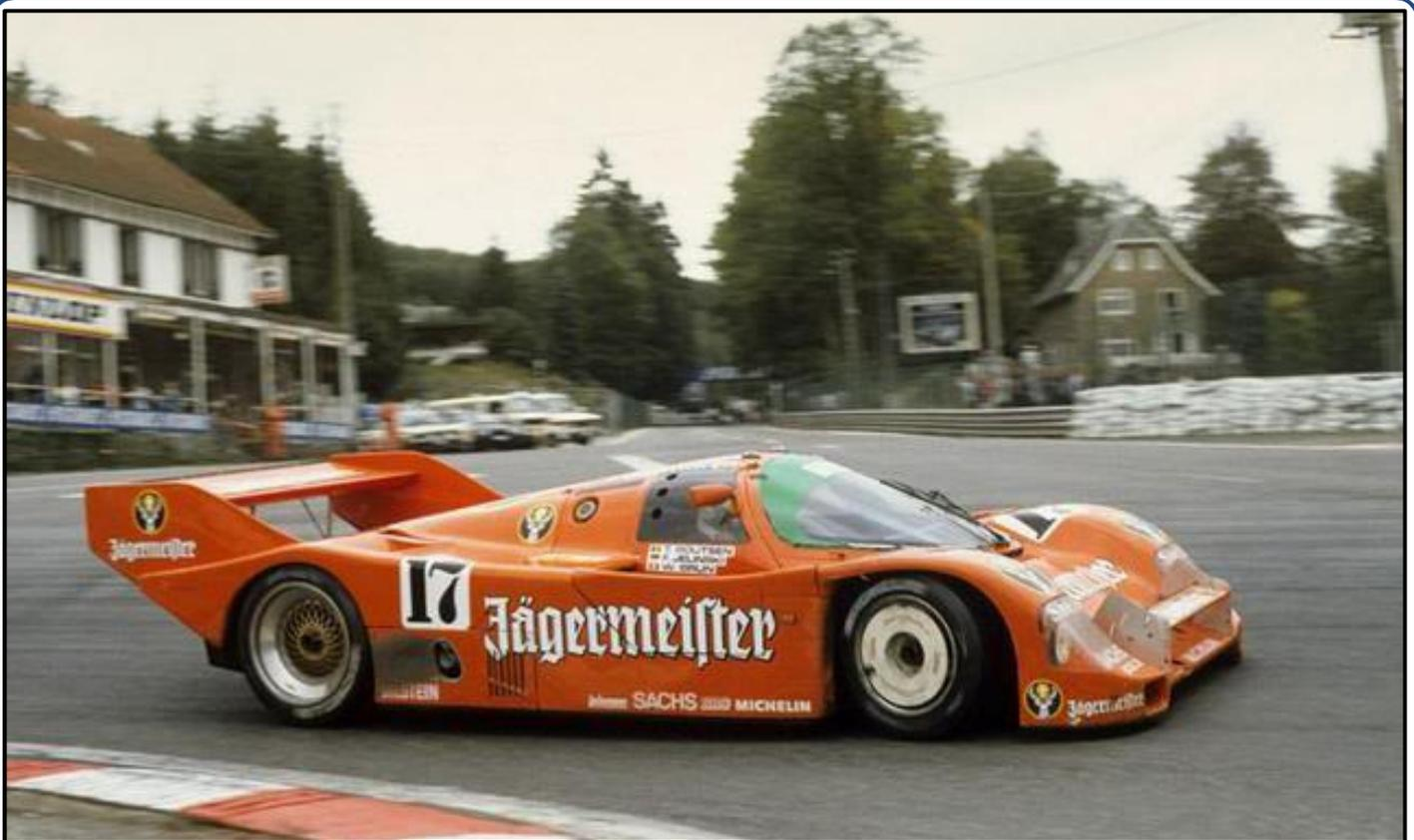
Pero dejemos los grupos y categorías de coches y pasemos a explicar el coche. Poseía un monocasco de aluminio y tenía un peso en vacío de entre 820 y 850kg. Montaba un motor boxer, típico de la marca, de seis cilindros y de 2650cc unido a dos turbos que le permitían rendir una potencia entre 620 y 640 cv a 8.200 rpm y tener un par máximo de 630 Nm a las 5.400rpm.
