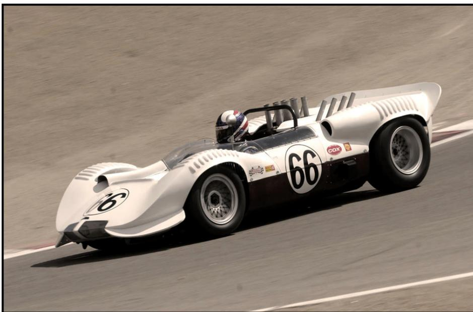
El modelo 2B seguía manteniendo la misma línea general que el 2A, con una altura total muy baja y una zaga muy afilada.
